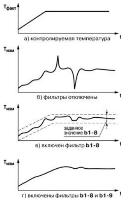
**Рисунок 3.2 – Временные диаграммы работы цифровых фильтров**
