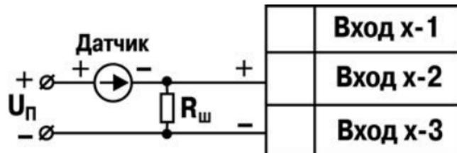
Рисунок Б.12 – Схема подключения активного датчика с токовым выходом 0...5 мА или 0(4)...20 мА
