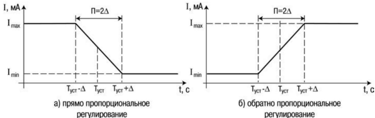
**Рисунок 3.13 – Принцип формирования управляющего тока П-регулятора**
